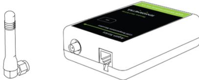
Schrauben Sie die mitgelieferte Antenne an den vorhergesehenen vergoldeten Stecker, sollten Sie eine eigene Antenne anschließen wollen, (z. B. Dachantenne, Magnetfußantenne) schrauben Sie diese nun an.
