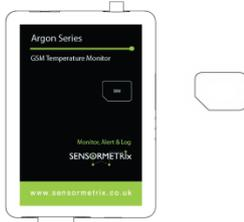
Setzen Sie eine Standard-SIM wie abgebildet vorsichtig in das Gerät ein, bis sie spürbar einrastet. Nehmen Sie ggf. einen stumpfen, schmalen Gegenstand um die SIM einzusetzen.
